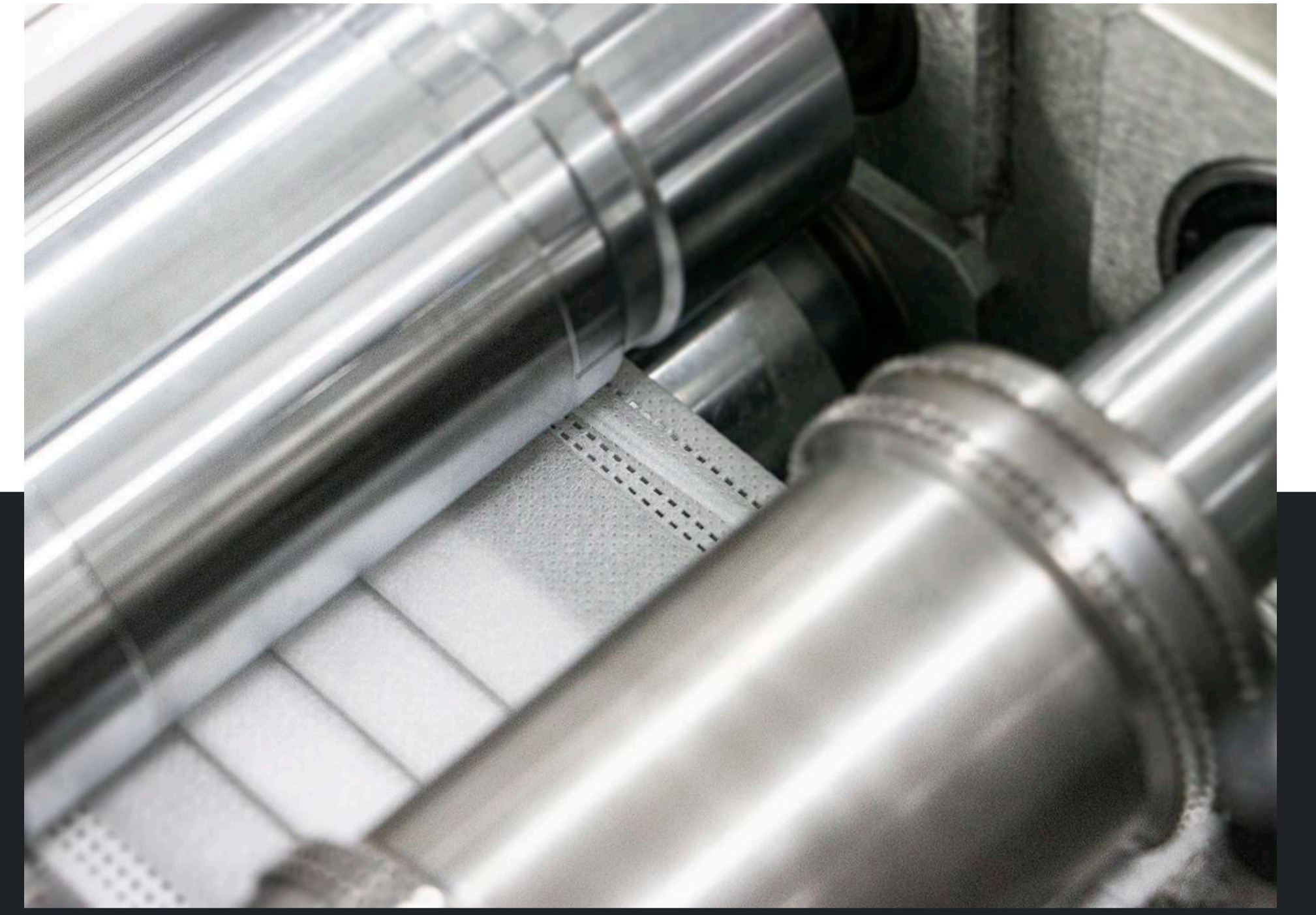
03. 초음파 용착 Ultrasonic Welding
